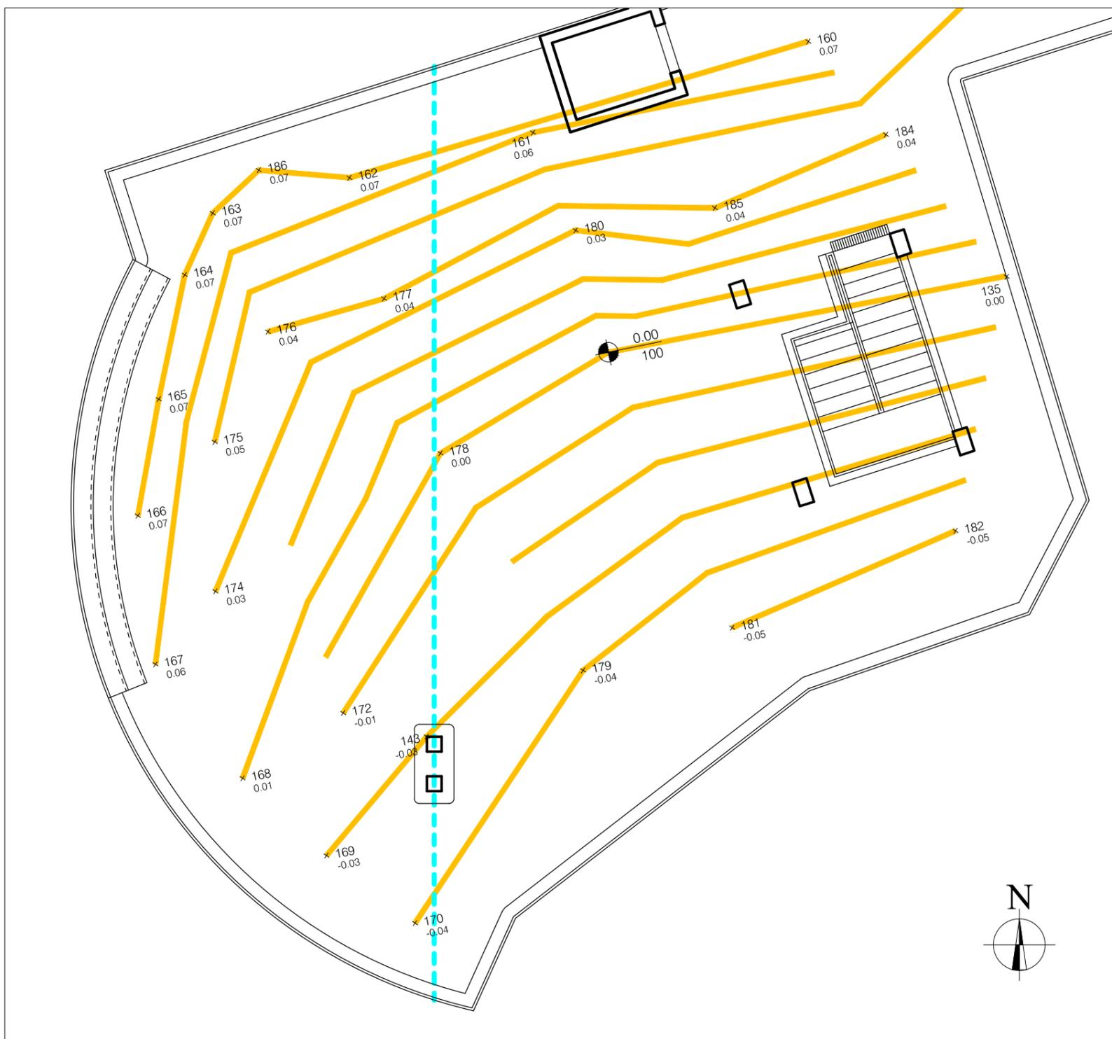
**5a** - Steso il massetto, previsto originariamente come un unico piano con una pendenza (per lo smaltimento dell'acqua piovana) ed una direzione "teoriche" stabilite, se ne verifica la reale giacitura, rilevandone il piano quotato e tracciandovi isoipse per visualizzarne la conformazione.
