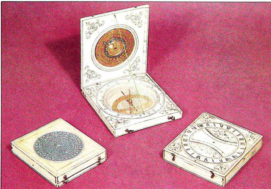
123, Orologio analemmatico portatile del tipo detto "di Dieppe", costruito in avorio nel 1666 da Charles Bloud. L'orientamento dello strumento è realizzato col metodo "magnetico". Un comune dittico con lo stilo filare è stato sovrapposto all'analemmatico.
